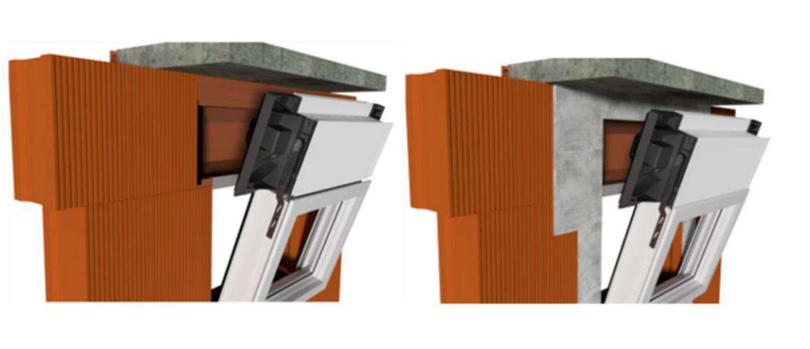
**Figure 15 : Exemple de mise en œuvre du bloc baie avec et sans bande de dressement**
