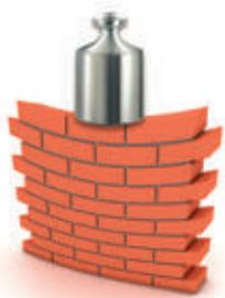
Les cloisons en briques supportent des efforts d'arrachement (efforts horizontaux perpendiculaires à la cloison) de 25 daN, soit environ 25 kg et des charges suspendues (charges verticales) de 50 daN, soit environ 50 kg.
