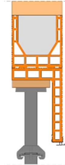
**Figure 22 : Fixation sous-dalle ½ CVR 27 avec Optibloc**
